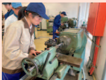
旋盤を使った金属加工
